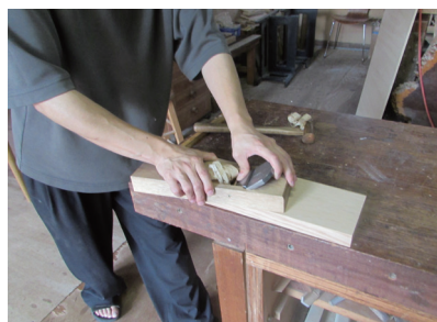
写真上：木材をフラットにする NC ルーター。正確に素早く仕上げる。 写真下：何千回も手ガンナをかけ、木目と自然なツヤを引き出す。
