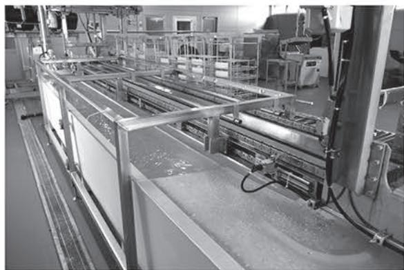
②瞬間冷凍機の高濃度塩水に数分浸す
