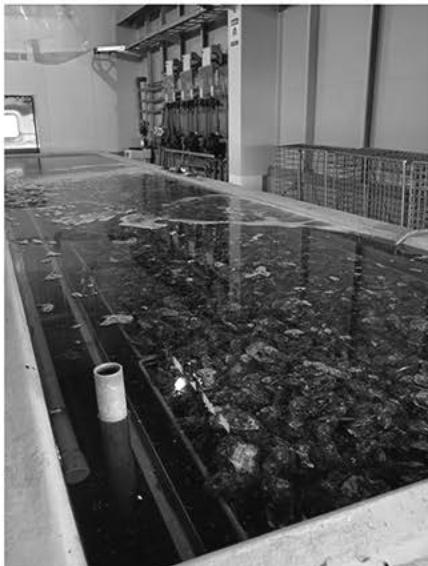
UV-LEDによる浄化装置を導入。浄化水に20時間浸けると、ノロウイルスなどをほぼ殺菌し、かつ牡蠣を活性化させる。
