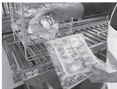
まず、牡蠣などの生鮮品を新鮮な状態で真空パックし、冷凍機に浸す。冷凍機にはシャーベット状の高濃度塩水が流れしており、わずか数分で完全に冷凍状態となる。そのため、解凍時のドリップが少なく（細胞壁が壊れない）、冷凍前と変わらない香りや食感・味となる。
