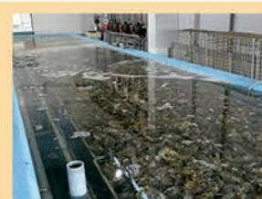
牡蠣の品質向上のために、UV-LEDによる浄化装置を導入。この浄化水に20時間浸けると、ノロウイルスなどをほぼ殺菌し、かつ牡蠣を活性化させる。
