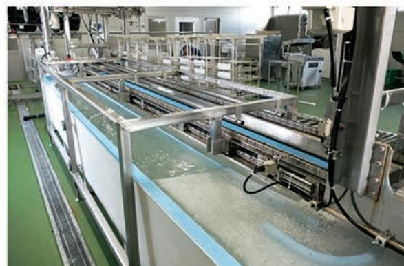
冷凍機にはシャーベット状の高濃度塩水が流れおり、液体でも-21度の状態を維持。塩水によりコストダウンを実現。
