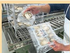
牡蠣などの生鮮品を新鮮な状態で真空パックし、冷凍機の高濃度塩水に浸すと、わずか数分で完全に冷凍状態となる。生食の牡蠣も冷凍で流通できる。
